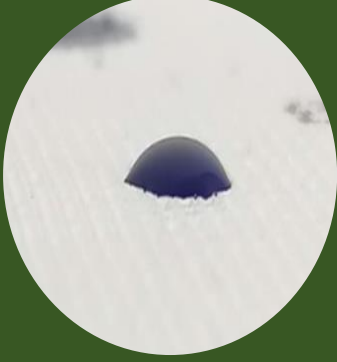
Plazma Uygulanmayan Yüzey
